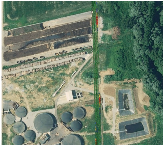
Obr. 4 Vizualizácia priebehu merania s rôznou intenzitou nameraného metánu v ovzduší
