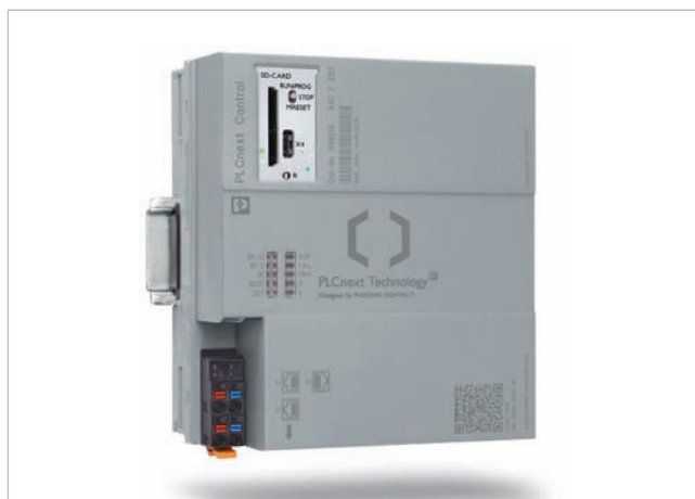
Obr. 4 Ako zariadenie PLCnext Control bol AXC F 3152 navrhnutý pre stredný výkonový rozsah s rozšírenými možnosťami komunikácie
